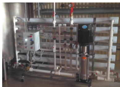
Обратноосмотическая система производительностью 3 м 3 /ч для производственной линии соков
